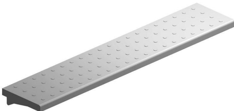
**Modèles** en tôle d'acier inox rabattables avec des parties en relève pour favoriser le glissement des plateaux, angles pliés et soudés, renforcement inférieur en aggloméré plaqué, profondeur 300mm.
