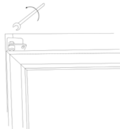
8. Den Stift vom oberen Scharnier spannen.
