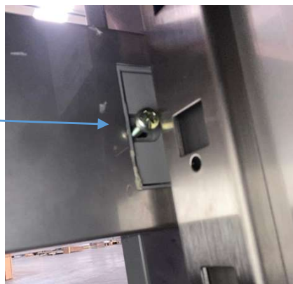
Foto 12: Bevestiging met afstandstuk.
