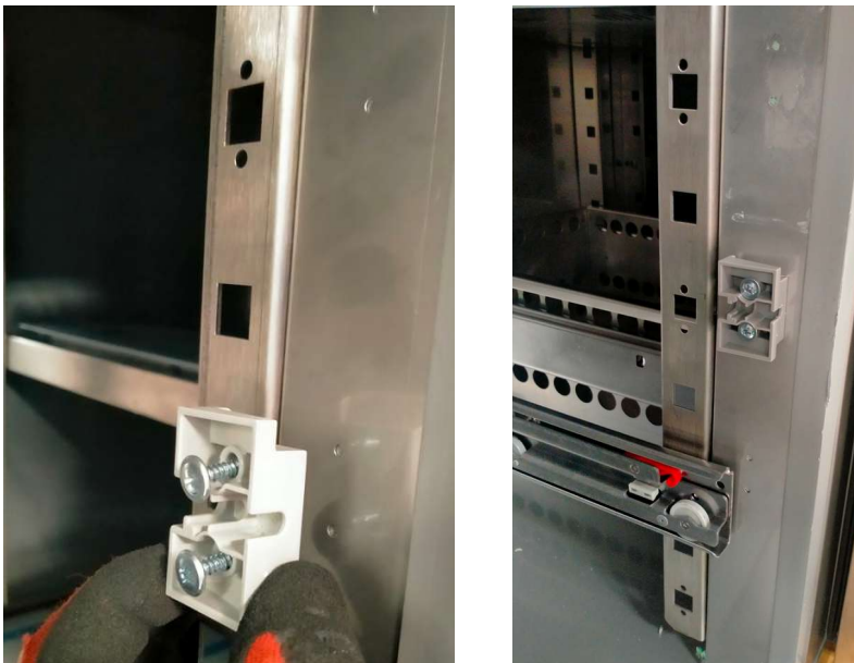
Foto 8: Montage der Abstandshalter.
