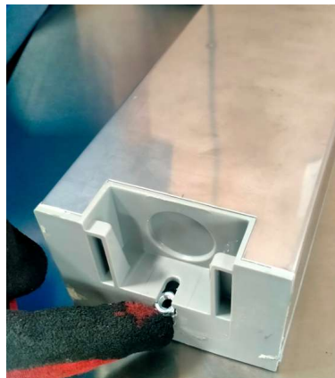
Foto 10:Montageposition der Distanzstücke mit Muttern und Schrauben.
