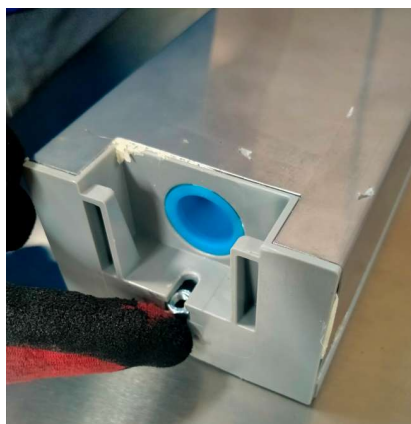
Foto 10: Posición de montaje de los espaciadores, con tuercas y tornillos.
