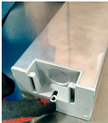
Foto 10: Posición de montaje de los espaciadores, con tuercas y tornillos.
