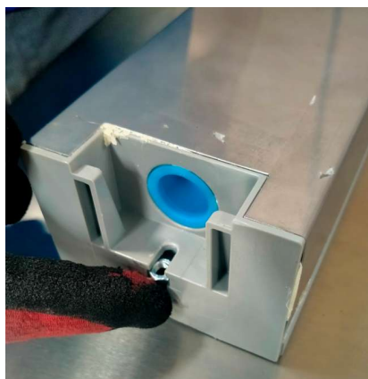
Foto 10: Posição de montagem do separador, com porcas e parafusos.
