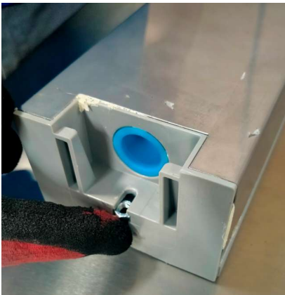
Foto 10:Montageposition der Distanzstücke mit Muttern und Schrauben.
