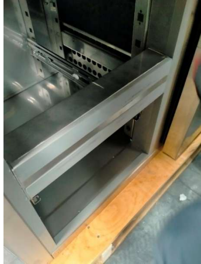
Foto 11: Das Distanzstück einsetzen.
