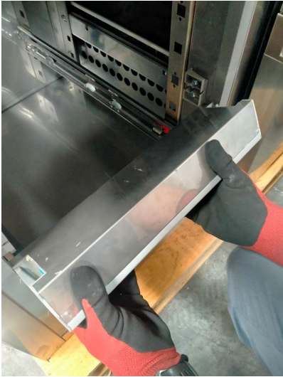
Foto 11: Das Distanzstück einsetzen.
