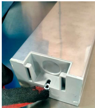
Foto 10:Montageposition der Distanzstücke mit Muttern und Schrauben.
