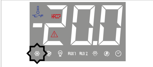
Este LED indica el estado (encendido o apagado) del COMPRESOR
