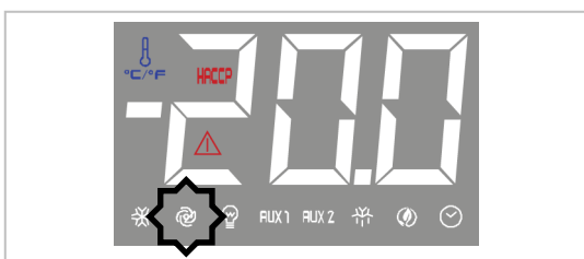
Questo LED indica lo stato (acceso o spento) del VENTILATORE
