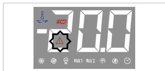
Este LED intermitente requiere la limpieza del filtro del condensador.
