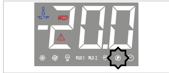
Este LED indica la activación de la función ENERGY SAVING
