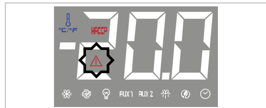
Este LED indica un estado de ALARMA / AVERÍA.
