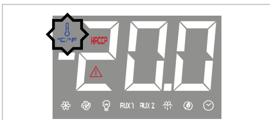
L'icona lampeggiante indica l'attivazione della funzione OVER COOLING
