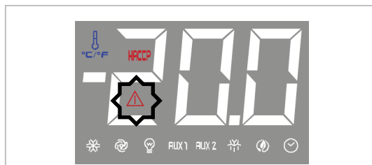
IL LED lampeggiante richiede la pulizia del filtro condensatore.
