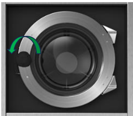
Bloqueo de la perilla: Gire la perilla en el sentido de las agujas del reloj hasta que se bloquee
