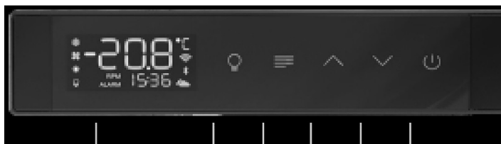
DUBBEL DISPLAY, TOETSEN>LICHT, MENU, OMHOOG, DW. AAN/UIT - Bovenste display met witte LED's, onderste display met blauwe LED's
