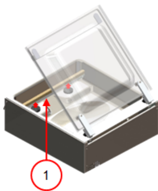
Schéma 18: Retrait de la barre de soudure (couvercle en plastique)
