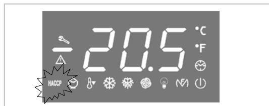
Este LED indica un estado de alarma HACCP.
