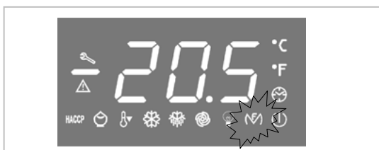
Este LED indica el estado (encendido o apagado) de las RESISTENCIAS PUERTA
