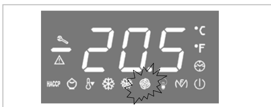
Este LED indica el estado (encendido o apagado) del VENTILADOR
