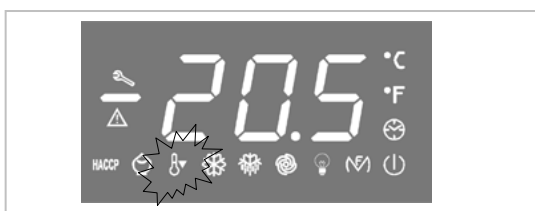
Este LED indica la activación de la función OVER COOLING
