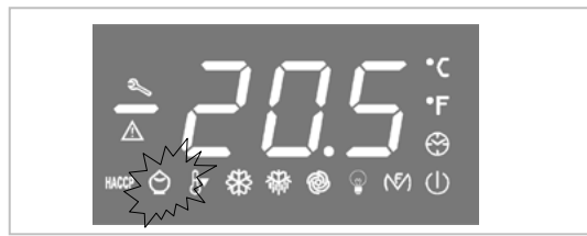
Este LED indica la activación de la función ENERGY SAVING
