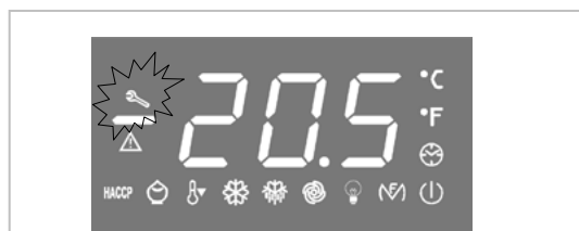
El LED se requiere la limpieza del condensador de filtro.
