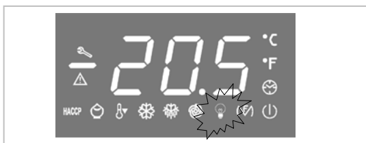
Este LED indica el estado (encendido o apagado) de la LUZ
