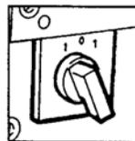
Agir sur l'inverseur placé sur la PIUNO en faisant tourner l'arbre dans le sens des aiguilles d'une montre, vers PETRISSAGE.
